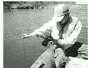
水中カメラによる水底状況の確認
